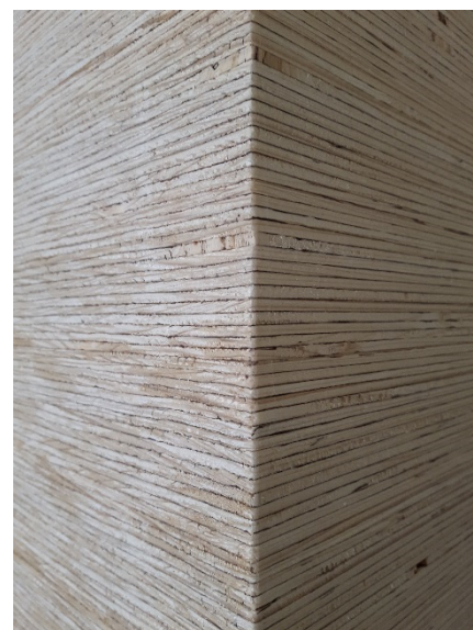
Kuva 1. Kerrannaisliimaamalla voidaan valmistaa hyvinkin paksuja ja järeitä rakenneosia.
